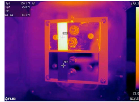
Sp1 – Sp2 温差T 电工胶带 45°C
